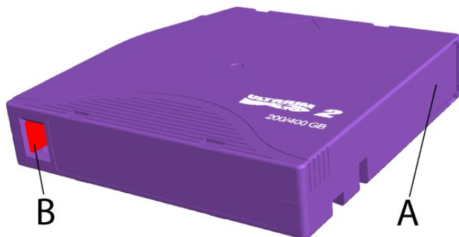
Abbildung 4: LTO-Cartridge mit Schreibschuttschieber
